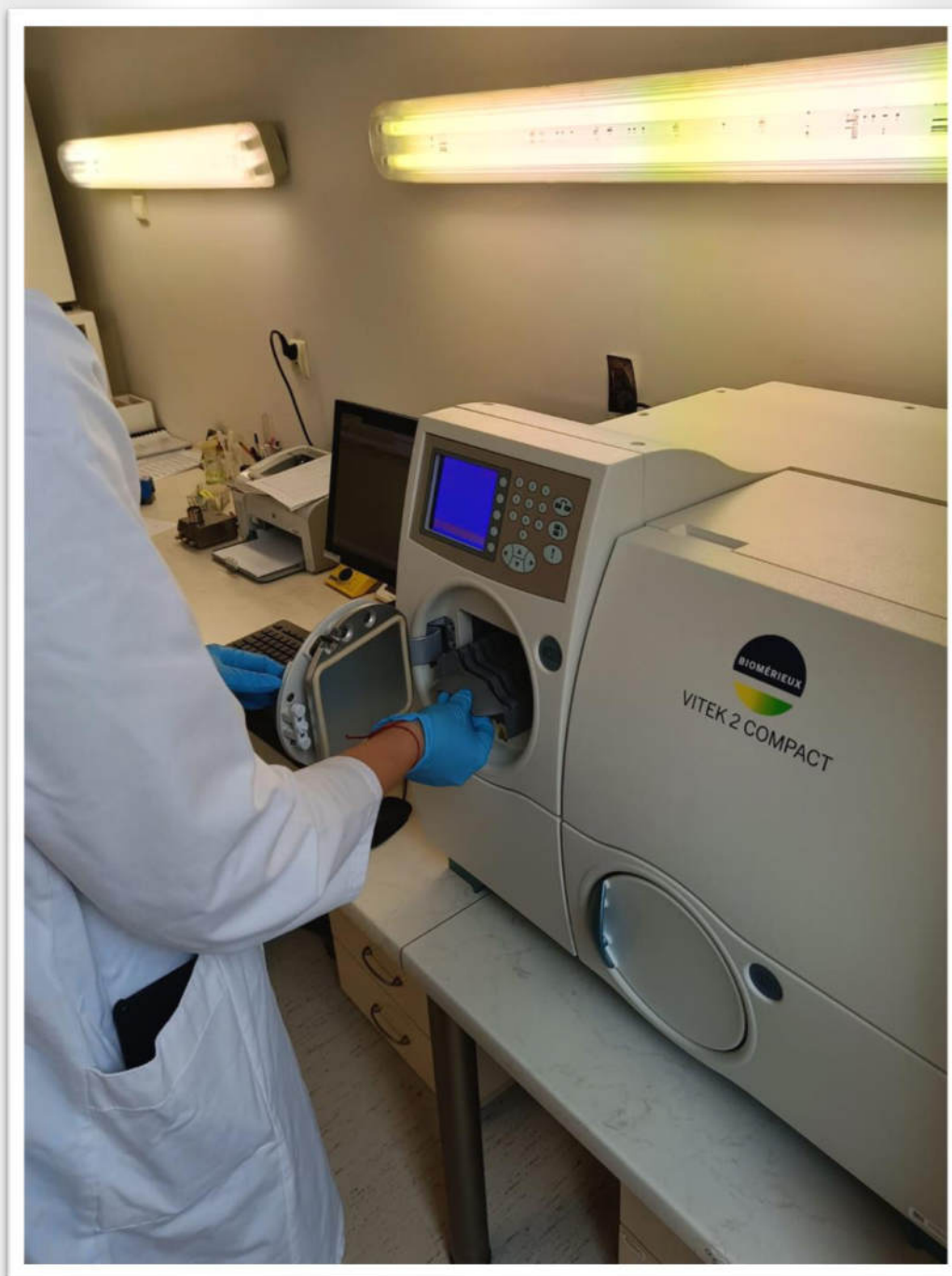
Zdjęcie nr 11. Identyfikacja biochemiczna mikroorganizmów przy użyciu automatycznego analizatora mikrobiologicznego Vitek 2 Compact 15 (fot: Iwona Fidura)
