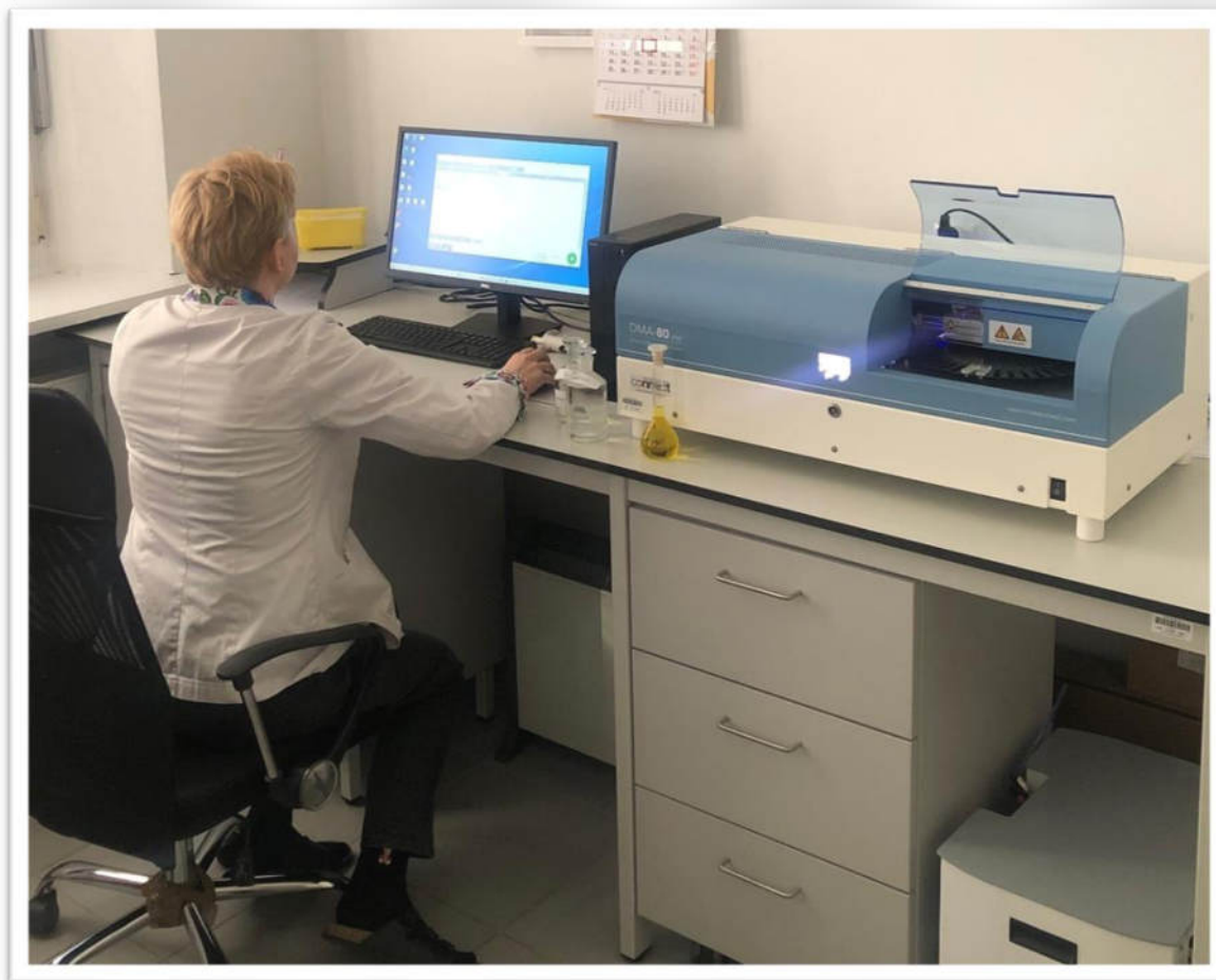
Zdjęcie nr 5. LPW Badania chemiczne wody przy użyciu Analizatora rtęci DMA-80. Autor fotografii Małgorzata Łanczkowska (fot. Nr 4 WSSE Białystok)
