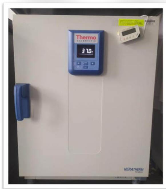
Zdjęcie nr 4. Ciepłarka wykorzystywana w badaniach mikrobiologicznych żywności i kosmetyków. Autor fotografii Justyna Czyrko-Horczak (fot. Nr 3 WSSE Białystok)
